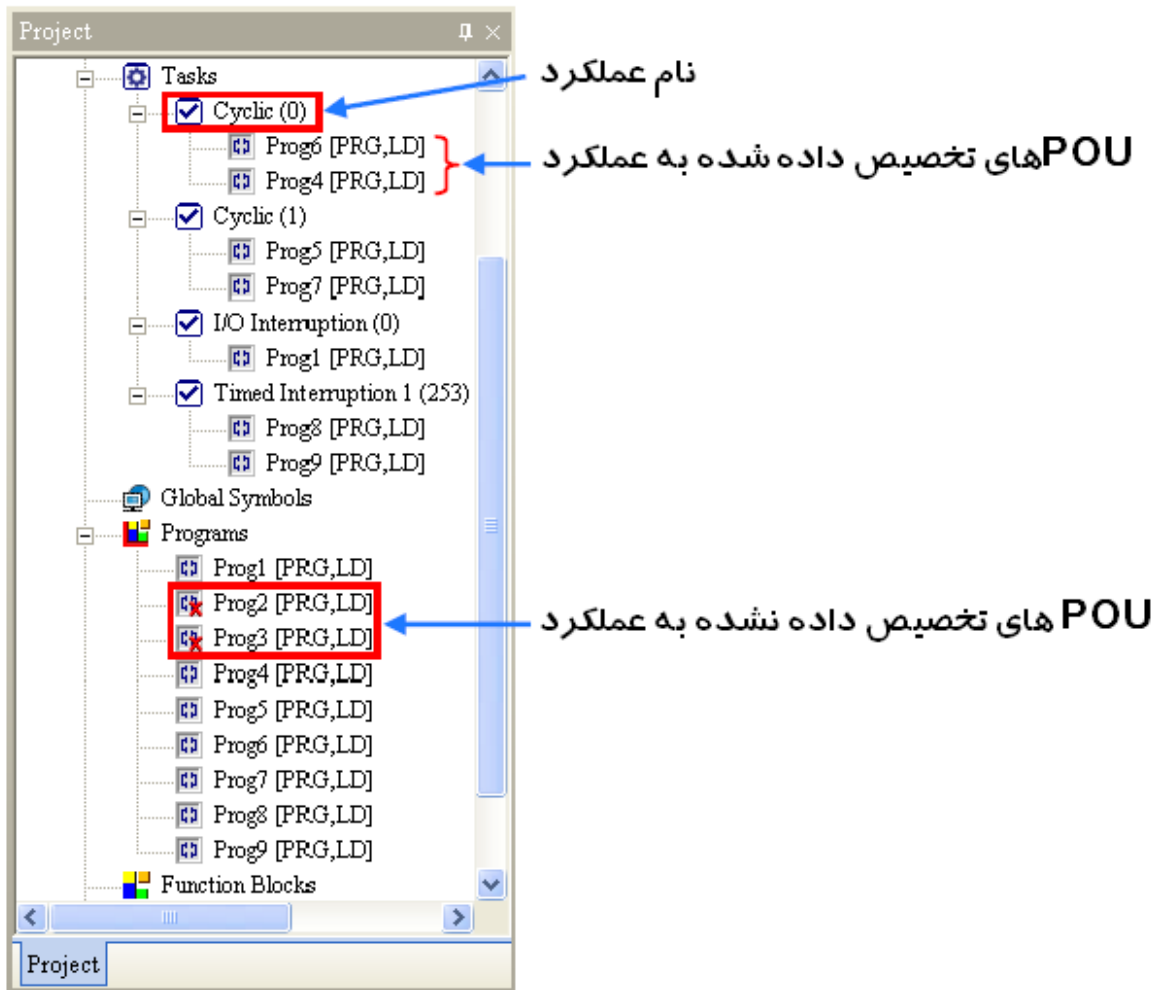
شکل ۴-۵ POU هایی که به آن‌ها عملکرد (Task) های متفاوتی تخصیص داده شده
