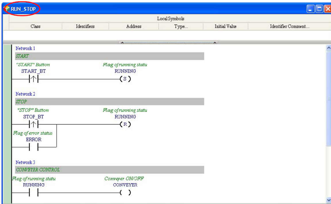
شکل ۶-۴۰ مثال: برنامه RUN_STOP پس از اضافه شدن سیمبول‌ها
