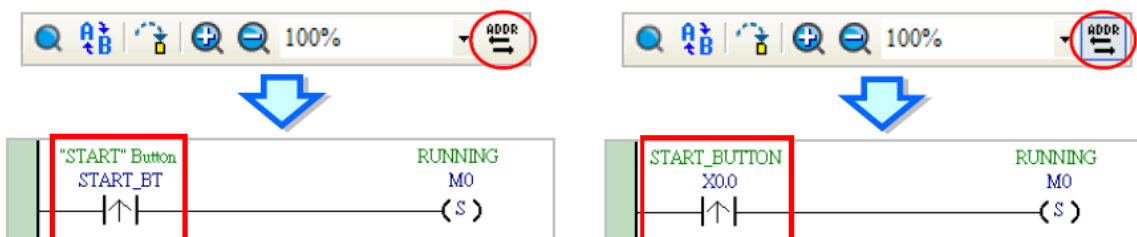
شکل ۳۸-۶ تغییر وضعیت حالت نمایش سیمبول و آدرس دهی مستقیم
