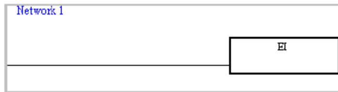
شکل ۵-۶ استفاده از بلوک EI برای فعال کردن وقفه
