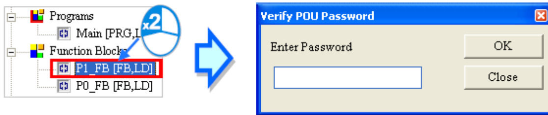
شکل ۹۴-۱۲ رمز عبور Subroutine
