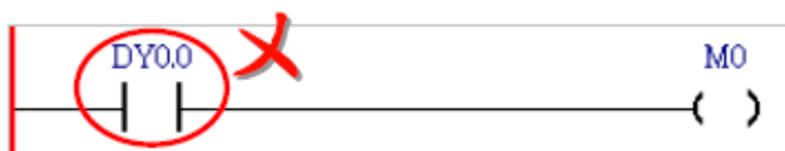
شکل ۱۲-۱۳۵ به روز رسانی نادرست مستقیم پورت های ورودی و خروجی - مثال ۳
