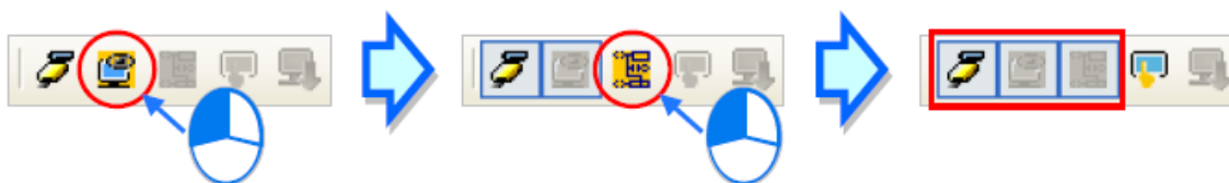
شکل ۴-۱۱ فعال کردن مانیتورینگ پورت ها و حافظه و سپس مانیتورینگ برنامه
