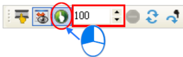
شکل ۱۱-۵۳ اجرای برنامه به دفعات مشخص در حالت عیب یابی
