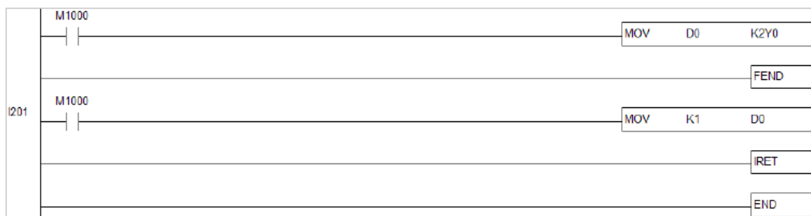
شکل ۵-۵۹ مثال ۲ - نتیجه حذف عملکرد POU های Run_Stop و غیر فعال کردن عملکرد Shift در
