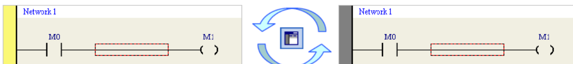
شکل ۸-۵۰ فعال / غیرفعال کردن Network
